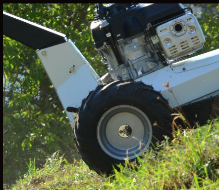
Aandrijfwielen met landbouwprofiel voor een betere grip
